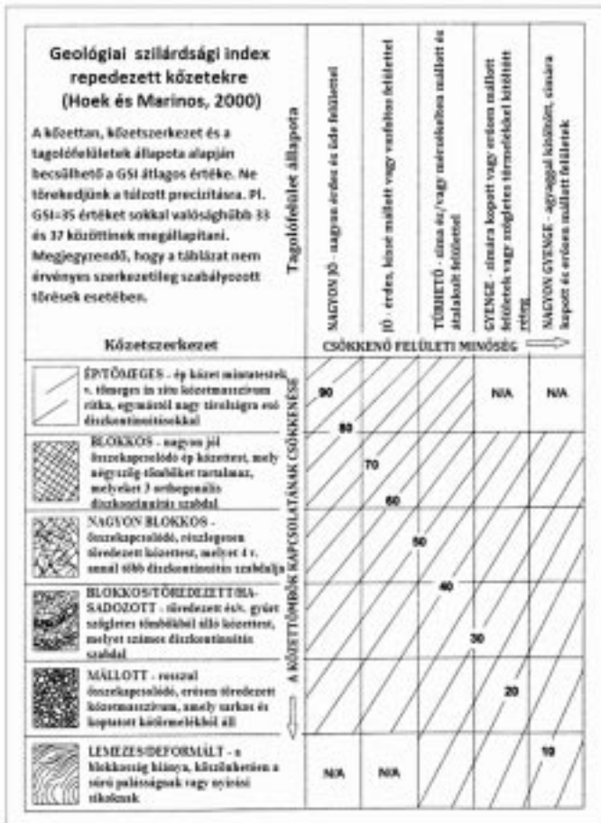
4. ábra: GSI alkalmazása repedezett kőzetekre
