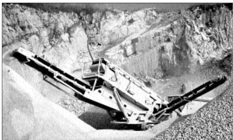
Nordberg ST 352 mobil osztályozó berendezés
