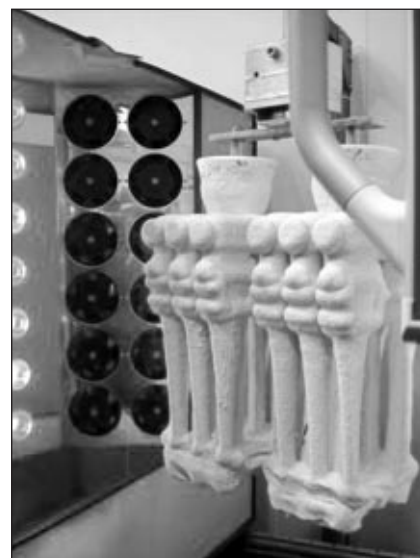
■ 17. ábra. Infra szárítókabin kerámiabokorral, MK Technology GmbH / Prototype Kft.
