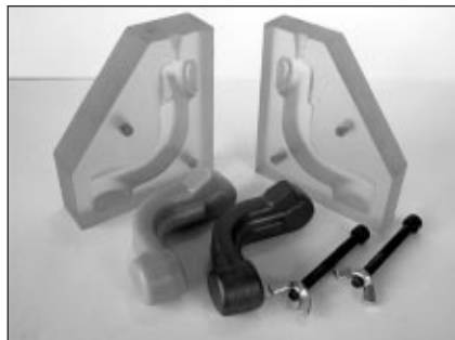
■ 13. ábra. Présszerszám, viaszminta, öntvény (Varinex Zrt.)
