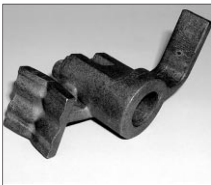
■ 16. ábra. Prototípus öntvény – Csepeli Precíziós Öntöde
