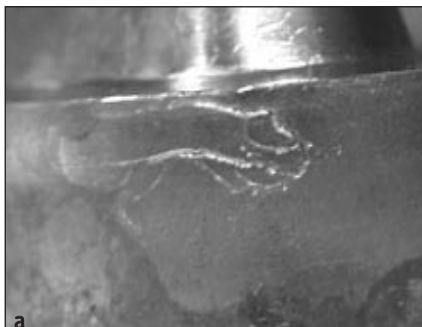
■ 11. ábra. Tipikus nyomásos öntészeti öntvényhibák. a – hidegfolyás, b – folytonossági hiány
