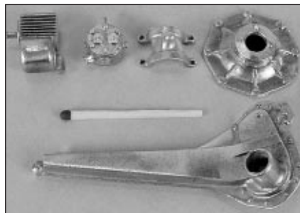
10. ábra. Gipszformázott öntvények (Caster Bronz Kft.)
