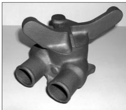
■ 15. ábra. Prototípus öntvény – Magyarmet Finomöntöde Bt.
