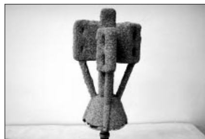
3. ábra. Kerámibokor, kézi mártás – Szegedi Finomöntőde
