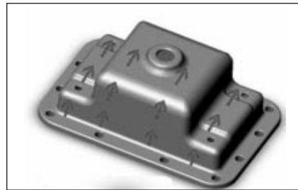
■ 3. ábra. Fémáramlás egy csésze alakú öntvényben
