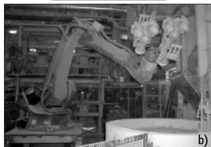
5. ábra. Kerámiamáz felvitele robotberendezéssel – Magyarmet Öntőde
