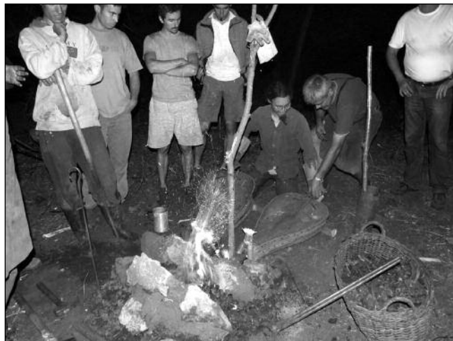
■ 2. kép. A vasbucá újraizzítása
