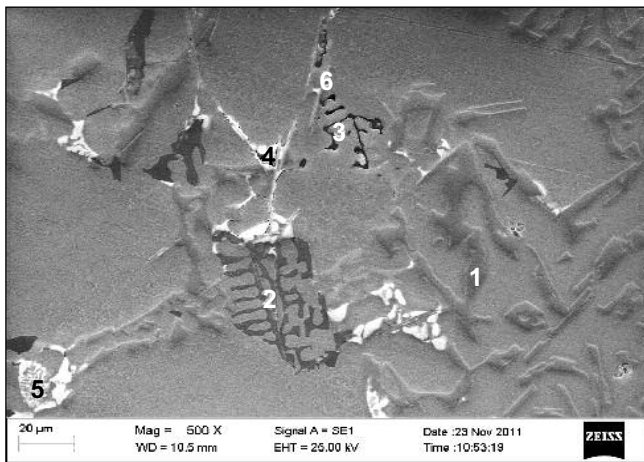
■ 7. ábra. Az AlSi9Cu1 (A319-labor) ötvözetben megtalálható ötvöző- és szennyezőelemek megoszlása fázisonként
