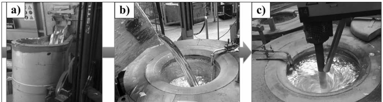
■ 3. ábra. A folyékony fém előkészítésének folyamata: a) olvasztás és csapolás, b) hőntartó kemencébe töltés, c) olvadékkezelés kezelőső adagolásával
