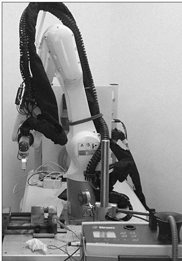
■ 2. ábra. A röntgendiffrakciós vizsgálatokhoz használt Stresstech Xstress Robot röntgendiffraktométer és az anyageltávolítás meghatározására szolgáló mérőóraállvány
