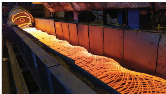
■ 1. kép. Első tekercs az új drótsoron
