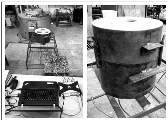
■ 4. ábra. Kísérleti összeállítás. Bal oldalon az alsó formaszekrény, a nyomástávadók és az adatgyűjtő. Jobb oldalon az alsó és felső formafél lezárt állapotban.
