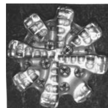
23. ábra: 8 1/2" FT813 fűró állapota kiépítés után
