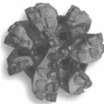
26. ábra: 6" FT713 fúró állapota kiépítés után
