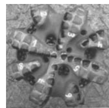
21. ábra: 8 1/2" FT813 fűró állapota kiépítés után
