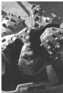
13. ábra: 8 3/4" KM424 hibrid fúró állapota fúrás után
