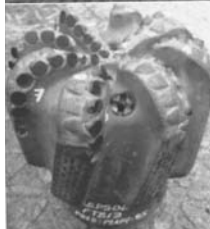
22. ábra: 8 1/2" FT813 fűró állapota kiépítés után
