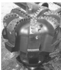
19. ábra: 18 1/2" FT816 fűró állapota kiépítés után
