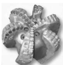
20. ábra: 13 1/8" FT616 fűró állapota kiépítés után
