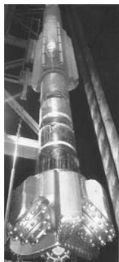
10. ábra: 26” Kymera™ hibrid fúró: Beépítés
