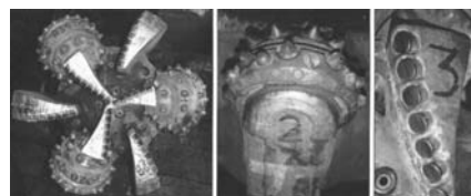
11. ábra: 26” KM633F hibrid fúró állapota 1144 méter fúrás után
