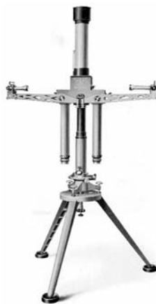
1. ábra: Torziós inga, Süss Mechanikai és Optikai Művek
