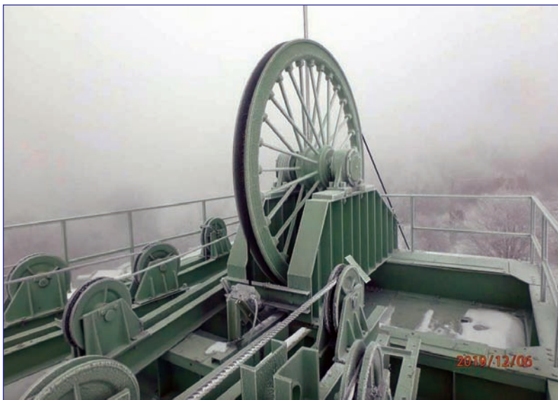
Az aknatorony korongpadozata
