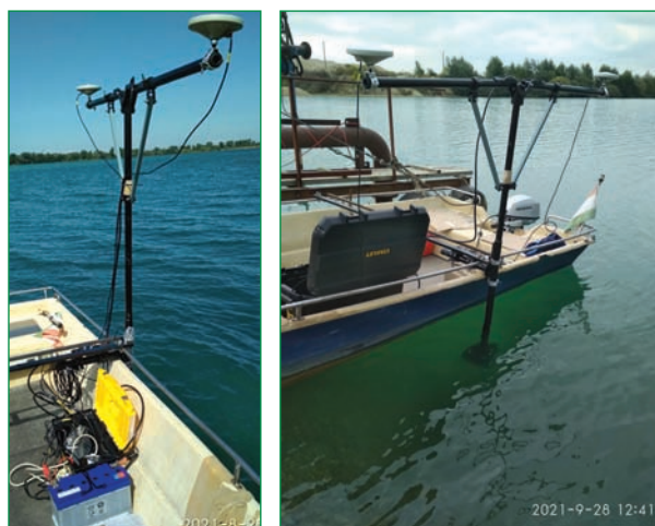
2. ábra: A mederfelmérésre összeállított többsugaras ultrahangos mérőrendszer
