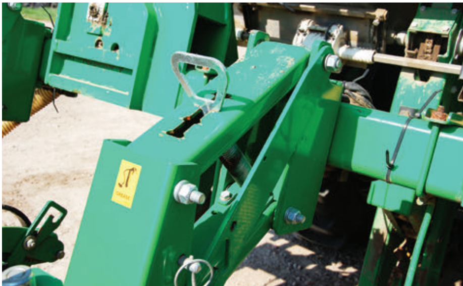
A Sfoggia talajnyomás fokozó rugóval is felszerelte a THEMA sorközművelőt, amivel beállíthatjuk, hogy milyen erővel húzza a talajba a kapákat
