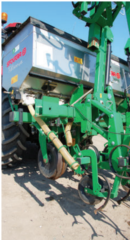
A szárnyak felcsukásakor a rendszer a munkaeszköz mellé húzza a két legszélső műtrágyaejtő csövet, hogy azok ne sérülhessenek meg vonuláskor
