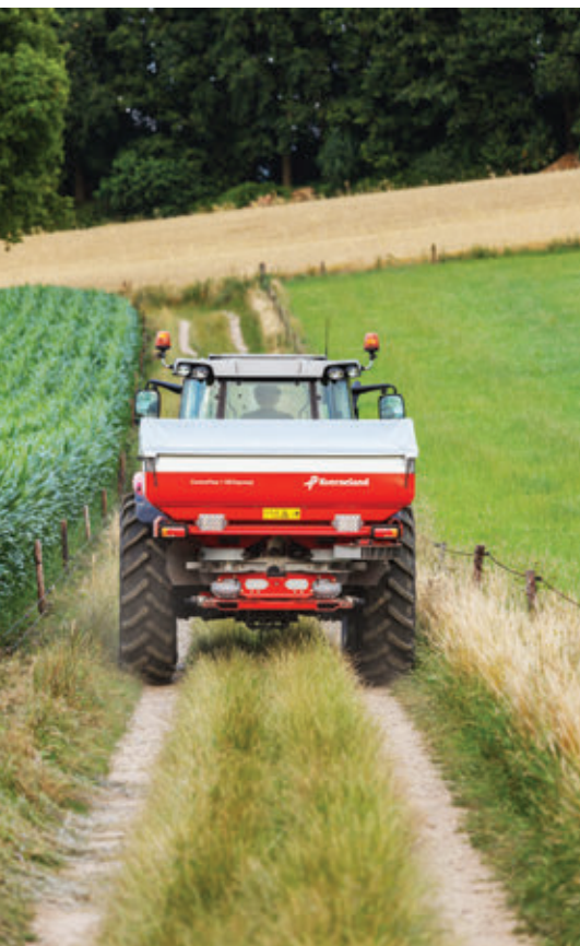
Kverneland GEOspread rendszer – 14 szakasz a tökéletes átfedésért
