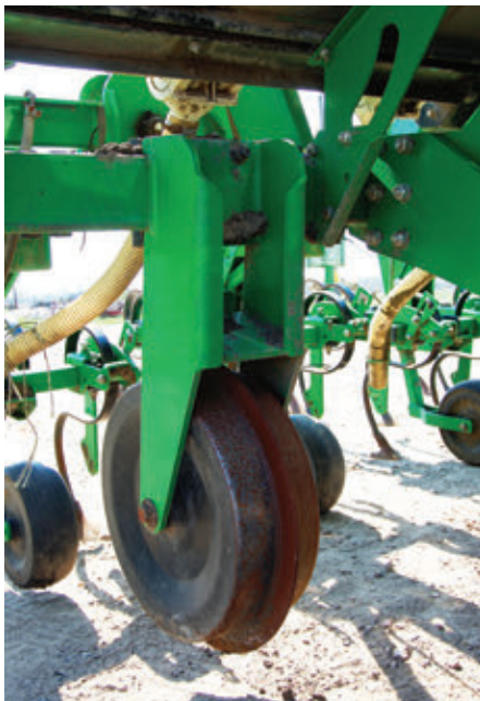
A támasztókerekek felületén elhelyezett él rendkívül stabilan és pontosan irányban tartja a Sfoggia munkaeszközt
