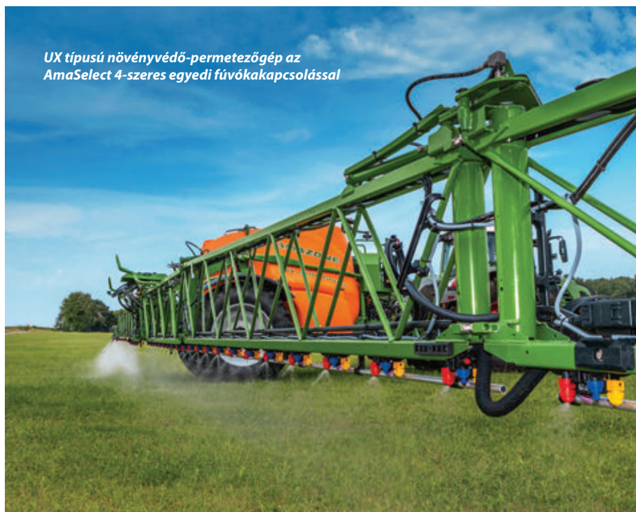
Amikor az AmaSelect elektromos egyedi fúvókakapcsolás a 4-szeres fúvókátartót a 25 cm-es fúvókátávolságra átkapcsolja, a HeightSelect a szórókeret és a célkultúra közötti távolságot automatikusan lecsökkenti
