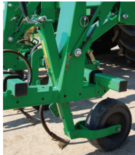
A THEMA mélységállítása egyszerűen és gyorsan elvégezhető a sorközművelő egységeken, ráadásul a mérőskála segítségével igen pontosan állíthatjuk be a kívánt értéket
