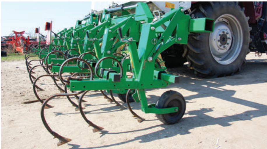
A rugós kapa bakhátat is képez a növény tövével, valamint a műtrágyát is közelebb tereli ahhoz
