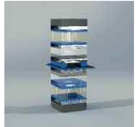
Az optikai mikrofon felépítése a lézerdíódával (középen) és a fotódíódákkal (lent és fent). A miniaturizált szenzor üveg-wafer-optikai technológiával valósult meg, és 4x4 mm alapterületű.
