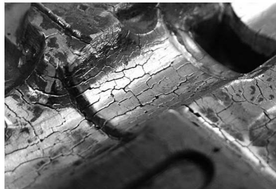
2. ábra Hőfáradási repedések kovácsoló-szerszámon
