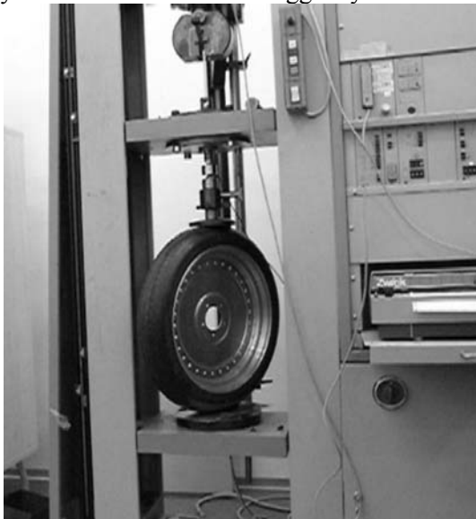
8. ábra. A függőleges rugóállandó mérése
