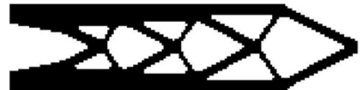
5. ábra. BESO megoldása (181,4 Nmm; 200(33))
