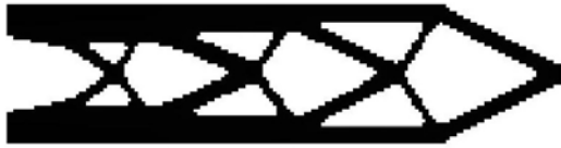
8. ábra. QSQF megoldása (184 Nmm; 200(52), inv.pow), V_0=0,7 ; ER=1,5\% ; H_s=0,5 ; H_d=0,4 (it.<40); \beta=4,5,6\dots
