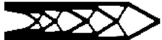
6. ábra. QSQF megoldása (181,3 Nmm; 200(31), pcw. ), V_0=0,55 ; ER=1,5\% ; H_s=0,5 ; H_d=0,5 (it. <30); \beta=4,6,8\dots
