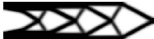
4. ábra. SIMP megoldása (201,2 Nmm; 200(32))
