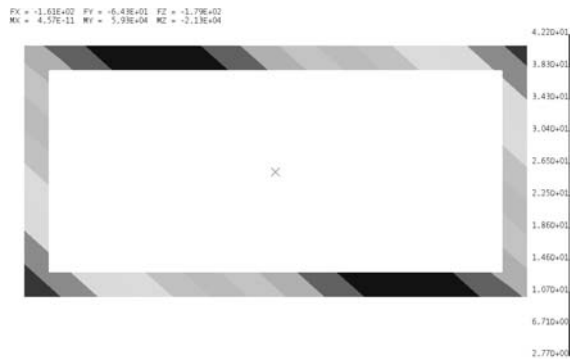
7. ábra. A redukált feszültség eloszlása a 3 jelű keresztmetszeten
