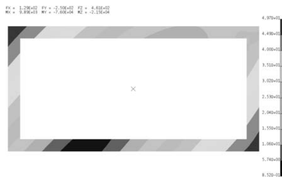
13. ábra. A redukált feszültség eloszlása a 7 jelű keresztmetszeten
