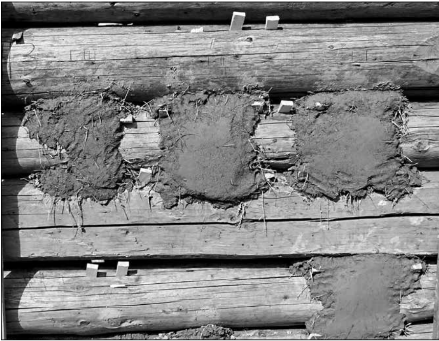
■ 6. kép: Tapasztási kísérletek. Sikerült és kevésbé bevált próbák ■ Photo 6. Plastering experiments. Successful and less successful attempts
