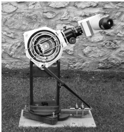
Pillantás a tubusba. Jól látszik a prizma – nem hagyományos – beszerelése
