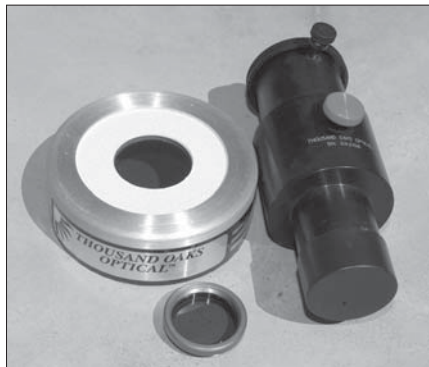
Az amerikai gyártmányú Thousand Oaks protuberancia-toldat és kiegészítői
