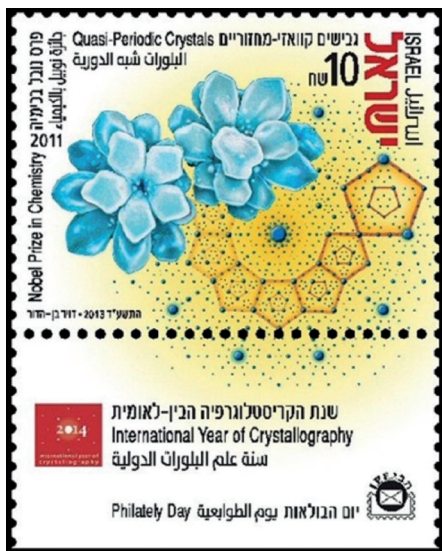
6. ábra. Az általam előállított kvázikristályok SEM-felvételét tartalmazó bélyeg (2014). A „hivatalos” leírás: A bélyegen látható, virágszerű kép alumínium-mangán ötvözetek ikozaédeses kvázikristályos aggregátumairól készült elektronmikroszkópos felvétel. Az ötvözetet 1985-ben állították elő Dr. Csanády Ágnes és kollégái a magyar alumíniumipari kutatóközpontban. A „virágok” háttéréül egy ikozaédeses kvázikristály elektron diffrakciós felvétele szolgál. Az ábra kiemeli a tökéletes ötös szimmetriát
