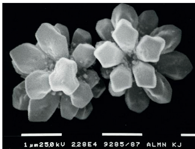
2. ábra. A mátrix feloldása után izolált AlMn-kvázikristályok SEM-felvétele (ez a felvétel jelent meg a Materials Science Forum 1987-es 22–24. számának előlapján)
