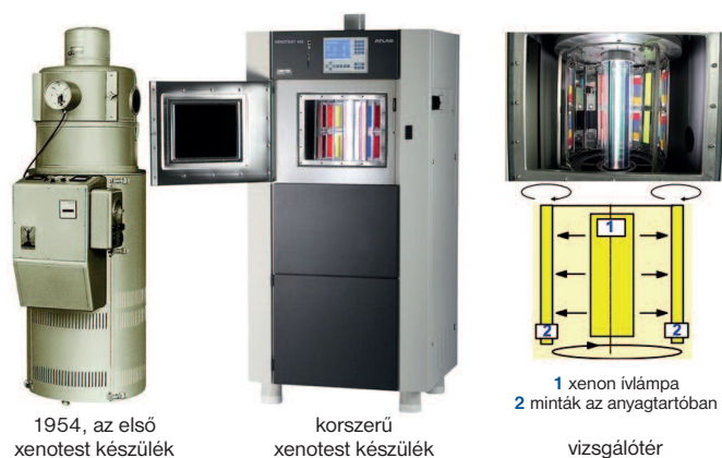
11. ábra. Xenotest készülékek és működésük
