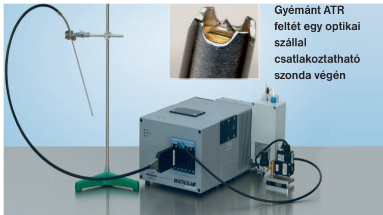
8. ábra. Bruker MATRIX-MF FT-IR spektroszkóp optikai szállal csatlakozó atr szondával [6]
