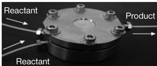
7. ábra. Egy mikroreaktor a 6. ábrán látható készülékből [4]
