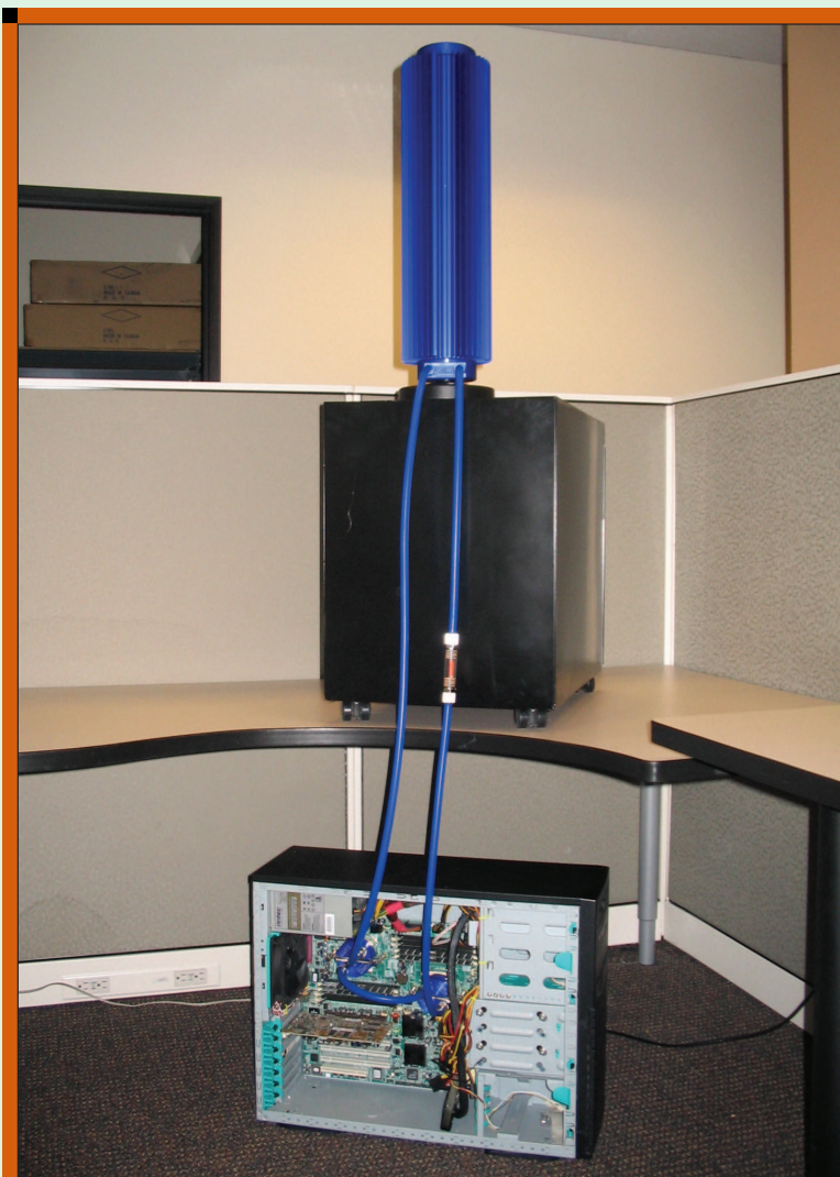
■ 1. ábra Mi van az irodádban, Justin? A hűtést egy nulláról induló rendszerrel, az lm_sensors segítségével teszteltük.
