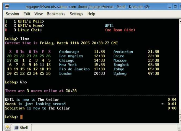
2. ábra A bbs100 elektronikus hirdetőtábla rendszer csevegőszobáinak és naptárainak fenntartásához mindössze néhány kB memóriára van szükség
