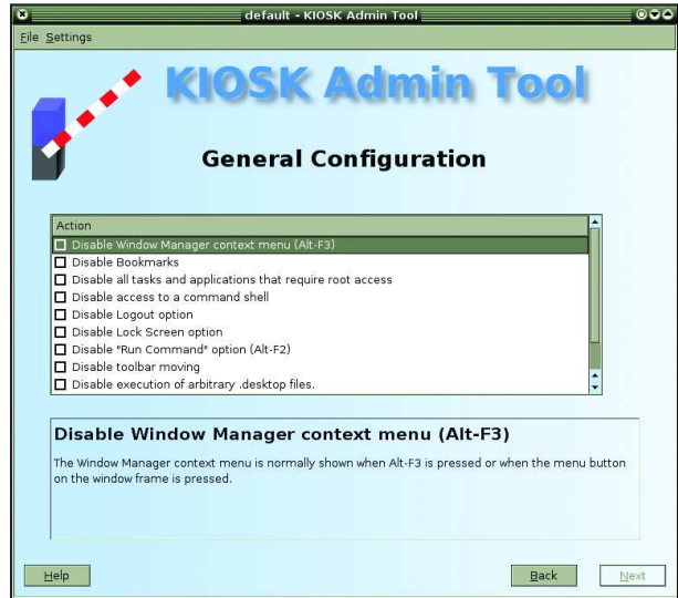
9. ábra A Kiosk Admin Tool segítségével a rendszergazda kiosk beállításegűtéseket hozhat létre és telepíthet
