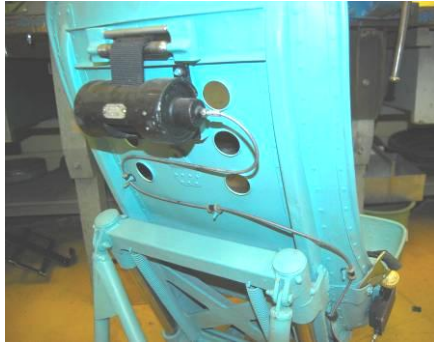
13. ábra első pilóta ülésén a bowden tok rögzítése
