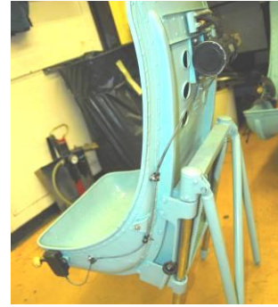
14. ábra másod pilóta ülésén a bowden tok rögzítése
