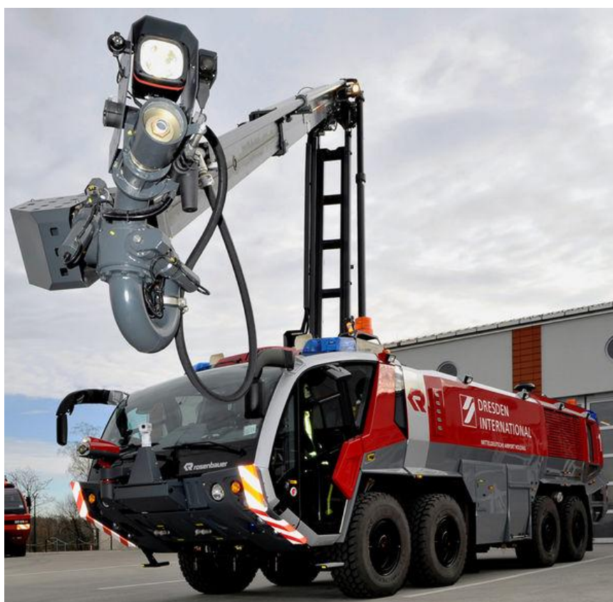
6. ábra. A beavatkozó gémmel (HRET) közelről 15
