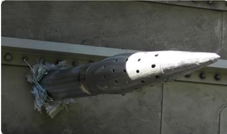
7. ábra. Oltódárda: a gép törzsén áthatolva a furatokon keresztül juttatja az oltóanyagot a törzsbe 16
