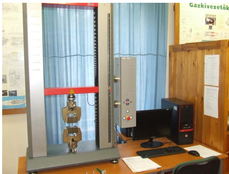
11. ábra. A szakítógép a vezérlő berendezéssel, valamint a adat feldolgozó számítógéppel
