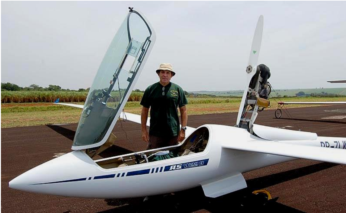
2. kép. A segédmotor minden nagyobb gyártó „kötelező” opciója lett 2
