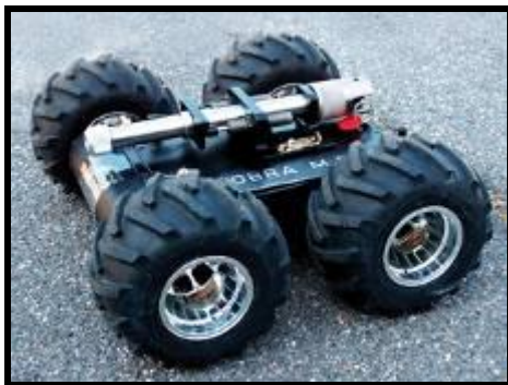
7. kép. A COBRA MK2 mini felderítő robot NEUTREX disruptorral és körkörös videó kamerával 18
