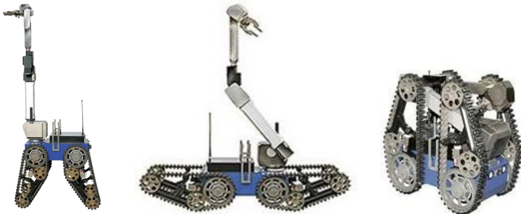
5. kép. A TELEMATX könnyű tűzserész robot, álló, gyorsjártatú és szállítási helyzetben 15
