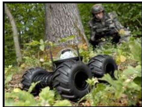
7. kép. A COBRA MK2 mini felderítő robot NEUTREX disruptorral és körkörös videó kamerával 18
