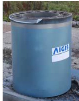
5. ábra. Robbanásálló szemétyűjtő eredeti és robbantási teszt utáni állapotában 6
