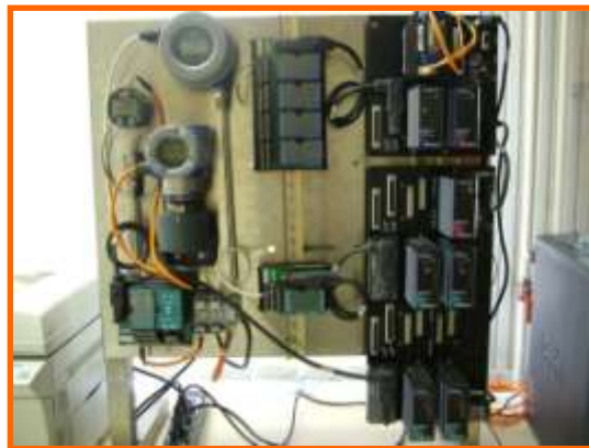
8. ábra. DCS demonstrációs rendszer
