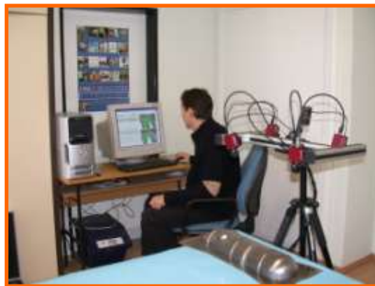
7. ábra: Optikai alakváltozás mérő rendszer
