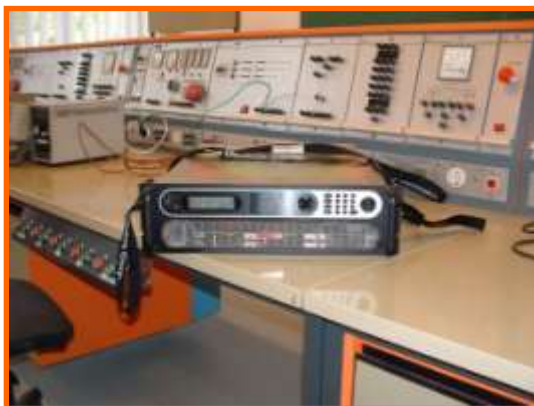
10. ábra. Nagyteljesítményű AC tápegység
