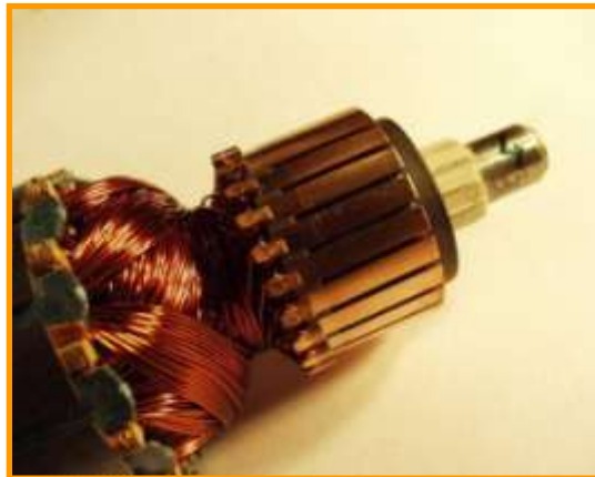
4. ábra. Vizsgált villamos forgórész
