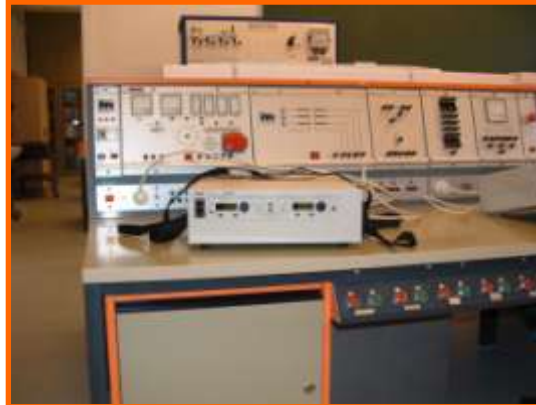
11. ábra. Nagyáramú DC laboratóriumi tápegység
