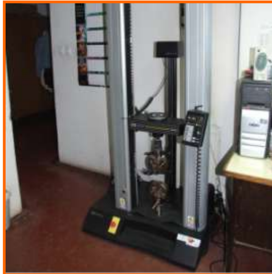
5. ábra. INSTRON 5566 univerzális anyagvizsgáló berendezés
