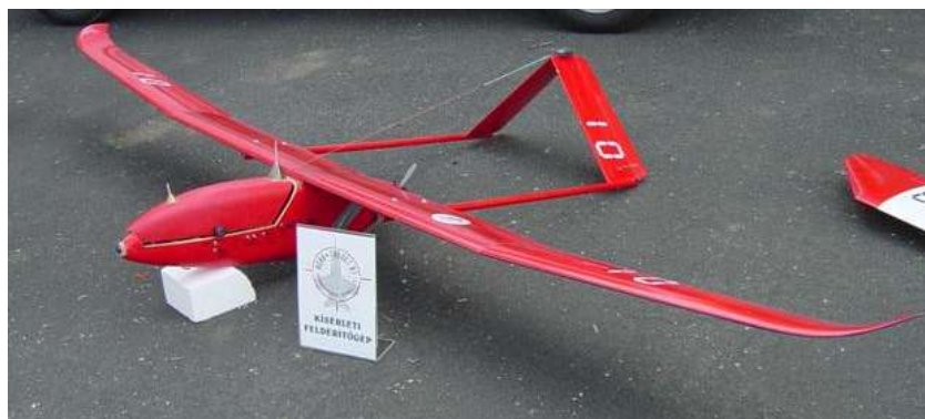
14. kép. Túzok – 1,5 kg hasznos terhelésű pilóta nélküli felderítő repülőgép
