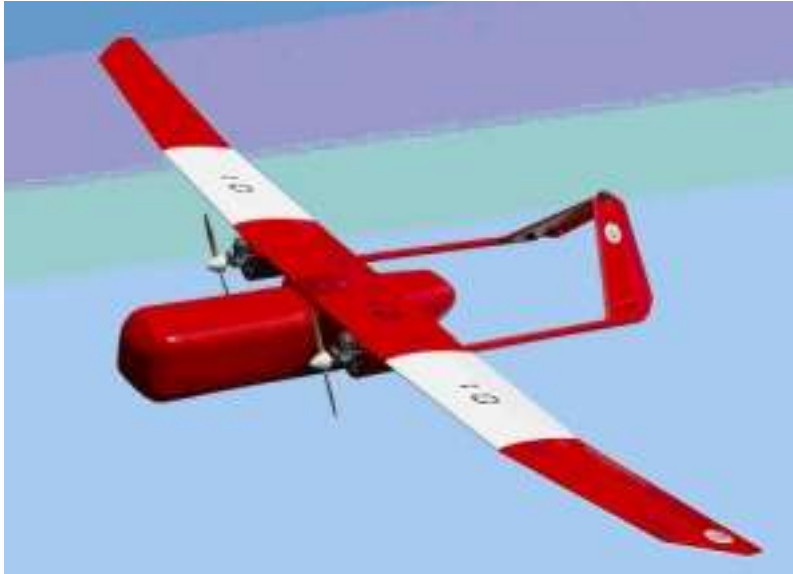
12. kép. Sas - 10 kg hasznos terhelésű, többcélú pilóta nélküli repülőgép
