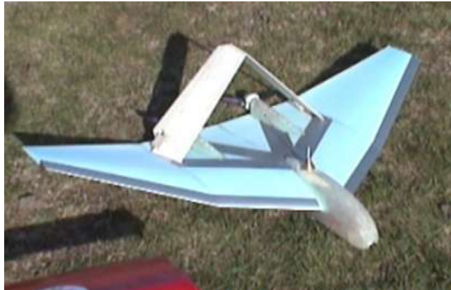
15. kép. Delta - 0.2 kg hasznos terhelésű „BACKPACK” pilóta nélküli repülőgép
