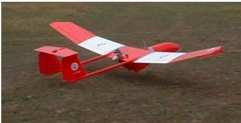
13. kép. Túzok - 3.5 kg hasznos terhelésű pilóta nélküli repülőgép
