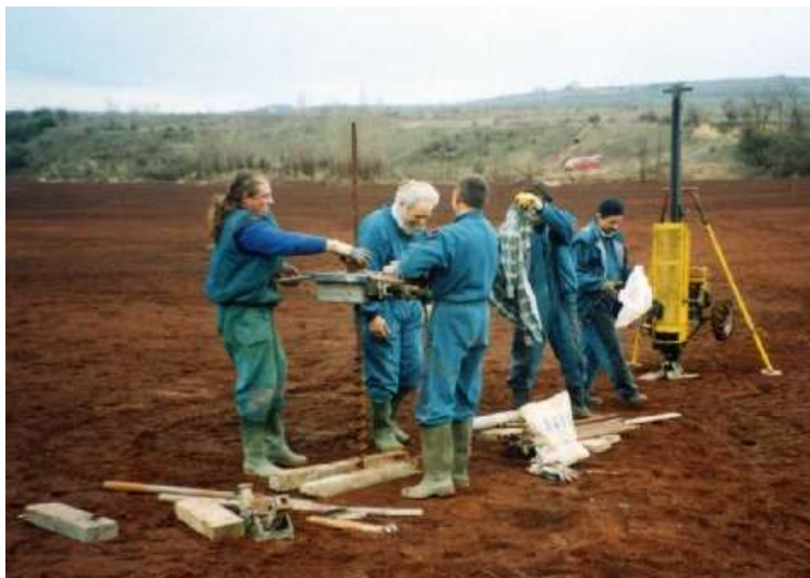
1. ábra. Mintavétel Borro típusú talajfúró berendezéssel
