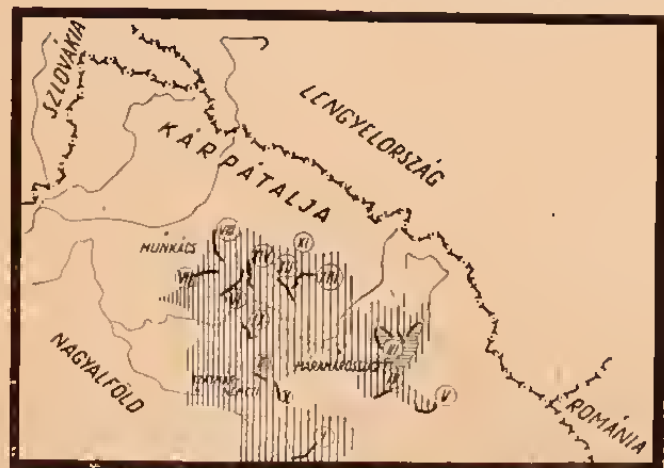
A MAGASSÁGI KORREKCIÓK KÉPZÉSÉHEZ SZÜKSÉGES SŰRŰSÉGHELYI ÉRTÉKEINK MEGHATÁROZÁSÁHOZ TÉRNETBE VETT GRAVIMÉTERES ÁLLOMÁS- VÉNYEK ELHELYEZÉSI VÁZLATA.
