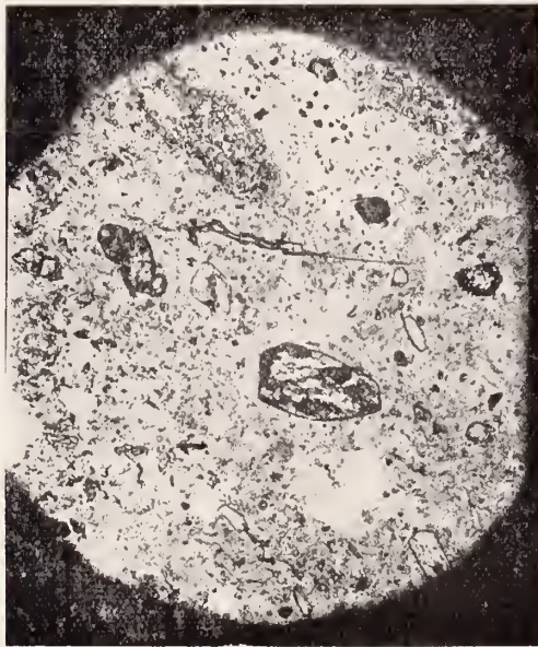
Fig. 1. Tuf de l'andésite à amphibole sous le microscope.
