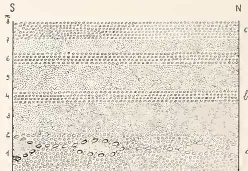
Fig. 2. ábra. Rákóskeresztur, községi kavicsbánya szelvénye (levantei). Profil durch die Gemeinde-Schottergrube von Rákóskeresztur. (levantisch). a) alsó durvább kavicsréteg, homoklenesékkal. — Untere, größere Schottersehicht mit Sandlinsen. b) vastag homokréteg, közbetelepült kavics rétegekkel. — Mächtige Sandschicht mit zwischengelagerten Schottersehichten. c) felső, finomabb kavics-réteg. — Obere, feinere Schottersehicht.
