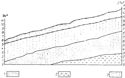
3. ábra. Szürkészöld és fehér bentonit-feltárás a Nagyrigócska-árok felső szakaszán. M a g y a r á z a t : 1. Riolitnyirok, 2. piroxénandezit lakkolit, 3. bentonittá alakult riolituffa. — Outcrop of greyish green and white bentonite in the upper section of the Nagyrigócska gully. E x p l a n a t i o n s : 1. Rhyolitic soil, 2. Pyroxene andesite laccolith, 3. Rhyolitic tuff altered into bentonite
