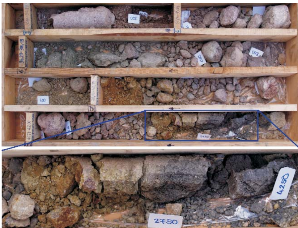
4. ábra. Részlet a Dinnyeberki Db-46 jelű fúrás érces szakaszáról. A papírcímkék a mért gamma intenzitást (cps) jelölik. BALOGH Zoltán felvétele, a WildHorse Energy Hungary Kft. engedélyével
