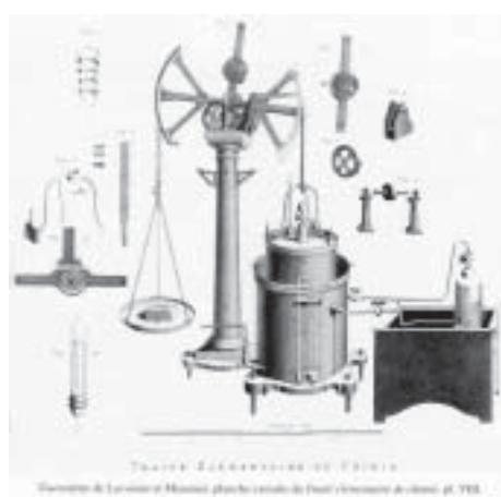
Lavoasier és Meusnier gazométerének ábrázolása – rézmetszet
