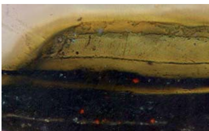
11. d. kép. A K2-es minta keresztmetszet csiszolatának mikroszkópos felvétele (370x). Többretegű lakkréteg, a lakkrétegek között lazúros rétegek.
