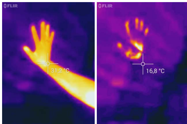
8. ábra. Hőkamerával készült felvételek. Balra a kéz, jobbra annak nyoma látható a pince felmelegített falán.
