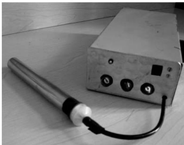
A Geiger-Müller-számláló háttérsugárzás mérése közben.
